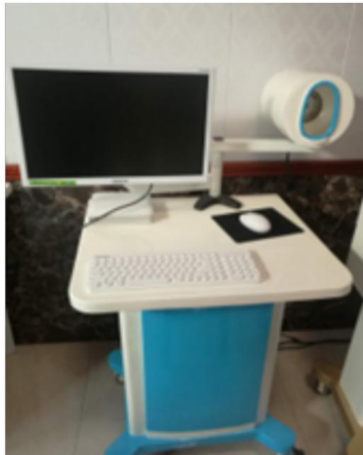
中医教学用模拟人系统的制作方法：脉象模拟单元利用电脑来实现脉象信号的模拟，该单元包括电脑，用于处理本发明的模拟人系统的输入/输出信号的控制、传输和处理；压力传感器及定位调节电路，将采集被训练者施加压力的大小，传递给电脑，电脑根据不同的压力，发出不同的信号，驱动电磁阀输出对应不同压力的脉象；机械控制系统，自电脑输出的电信号进入该机械控制系统，用于根据该电信号的规律控制油路；油路，用于模拟人体的静脉系统。
